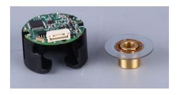
康比利公司与你分享下编码器常见故障编辑1、编码器本身故障:是指编码器本身元器件出现故障,编码器(图2)导致其不能产生和输出正确的波形。这种情况下需更换编码器或维修其内部器件。2、编码器连接电缆故障:这种故障出现的几率比较高,维修中经常遇到,应是优先考虑的因素。通常为编码器电缆断路、短路或接触不良,这时需更换电缆或接头。还应特别注意是否是由于电缆固定不紧,造成松动引起开焊或断路,这时需卡紧电缆。3、编码器+5V电源下降:是指+5V电源过低,通常不能低于4.75V□造成过低的原因是供电电源故障或电源传送电缆阻值偏大而引起损耗,这时需检修电源或更换电缆□4□juedui式编码器电池电压下降:这种故障通常有含义明确的报警,编码器(图3)这时需更换电池,如果参考点位置记忆丢失,还须执行重回参考点操作。5、编码器电缆屏蔽线未接或脱落:这会引入干扰信号,使波形不稳定,影响通信的准确性,必须保证
