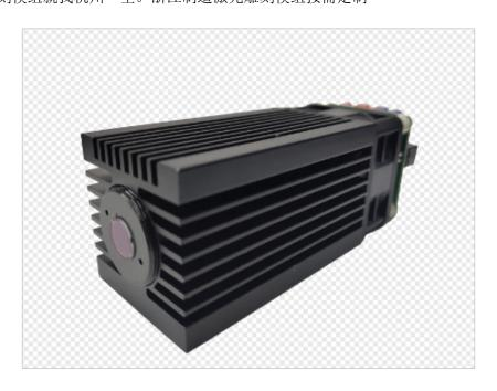
激光雕刻模组的特点: 1、光斑细且清晰,发散角度小,准直性好,体积小。2、温控、驱动和激光器完全集成,结构小巧紧凑,外部只需直流供电。3、经过高低温存储和振动冲击测试,具有可靠的稳定性,温度在-10~40度范围时,可连续24小时稳定工作。4、精密科学的散热设计、双向温控和完善的温度保护功能,可以尽可能的延长激光器的寿命。杭州一全光电有限公司的激光雕刻模组属于蓝光模组,可应用于不锈钢雕刻,陶瓷雕刻,木头切割,亚克力切割,铜皮切割,氧化铝材雕刻打标等多种用途。此类型的激光雕刻模组可以帮助客户实现雕刻打标画图等等不同目的和用途,可非标按需定制。浙江制造激光雕刻模组按需定制激光雕刻模组在日常生活中都有哪些作用?
